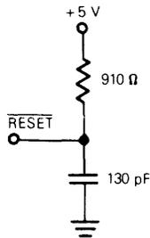
Figure 8-1.  $\overline{\text{RESET}}$  Test Load
